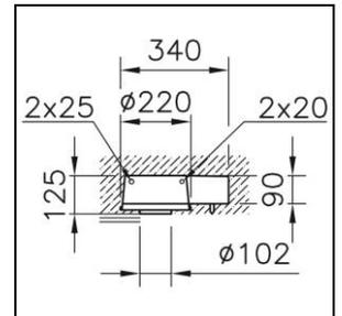
Einbetoniergehäuse B.Box aus Kunststoff, mit Tank für Betriebsgerät,
